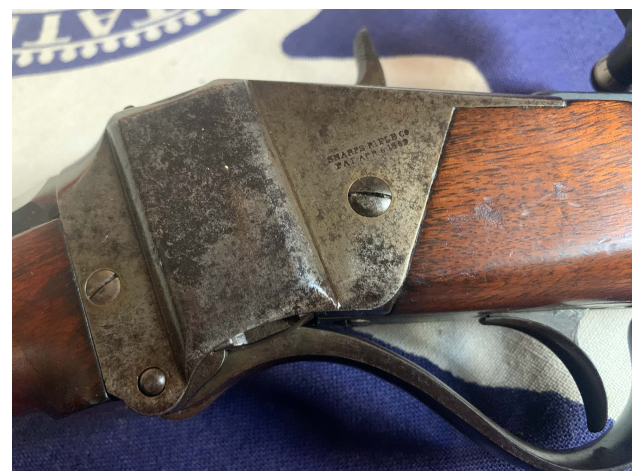
Fig 6 – bloc culasse côté opposé à la platine avec les marquages de brevet Sharps
