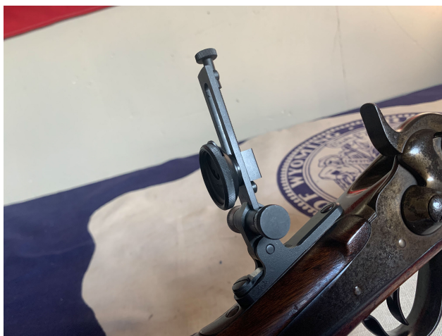
Fig 13 – Le dioptre « Soule Sight » est une concession à la modernité mais peut facilement se démonter sans laisser dioptrés de qualité excellente. aucune trace sur une arme d'origine.
