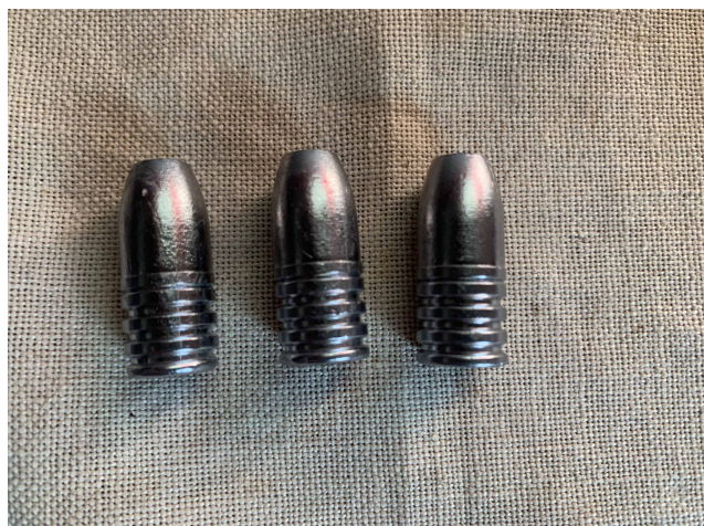
Fig 9 – Ogives en sortie de moule, calibre .446 poids 395 grains en plomb quasi-pur.
