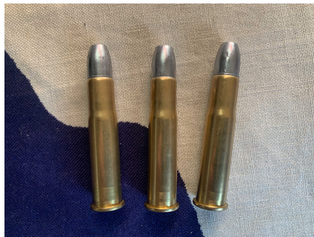
Fig 11 – Etuis de 44-77 formés à partir de 348 Winchester, Fig 12 – les cartouches prêtes à l'emploi. fabriqués par Shiloh Rifle et trouvés en Allemagne chez Gebu-waffen.de
